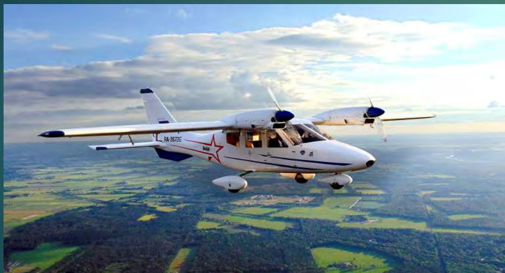
Многоцелевой четырехместный двухдвигательный самолет МАИ-411
